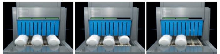
Der M-iQ *GreenCoach* signalisiert via grünem Ampelsignal, welche Spuren an der Geschirraufgabe bestückt werden sollen. So läuft die M-iQ unter optimalen Bedingungen.
